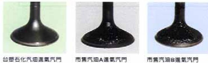
圖三：台塑石化汽油已添加適量添加劑，進氣汽門積碳最少。
